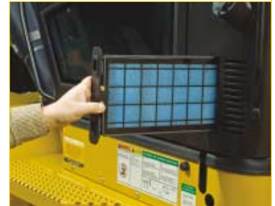
Filtro aria facilmente accessibile dalla cabina
