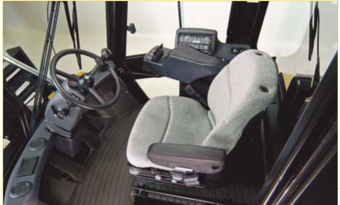
Carrello con cabina chiusa opzionale con pomello girevole dello sterzo e sedile rivestito completamente molleggiato
