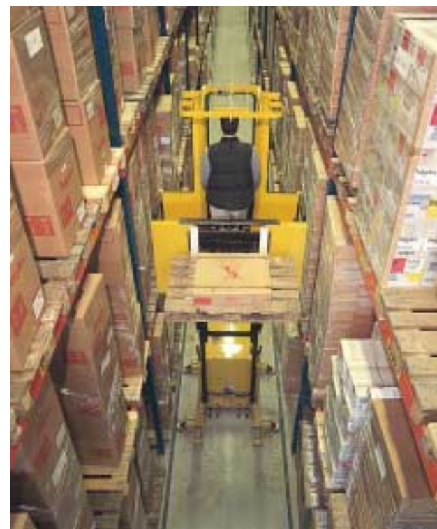
I rulli guida consentono ai modelli MO6-MO10S di operare in corsie di poco più larghe del carrello e del carico.
