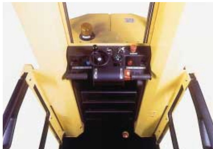
La console di controllo è stata spostata indietro all'interno della cabina per ottenere il massimo spazio calpestabile.
